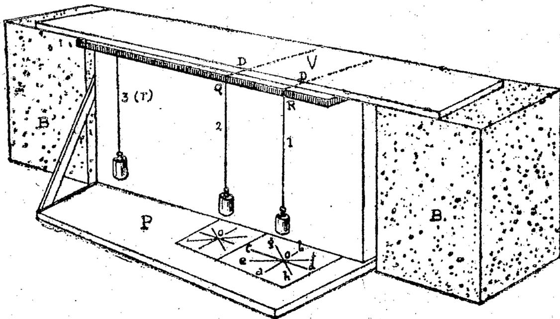
B.B., plots de béton; Q,R, plaque de bois; D,D, fils de suspension; 1,2,, pendules pour expériences; 3. pendule de contrôle; V. plaque de verre trois millimètres au-dessus de D.D. et entièrement sans contact.
